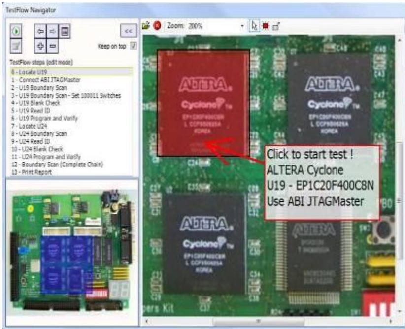
Le Test Flow permet aux utilisateurs de créer simplement des séquences de test automatisées structurées pas à pas. Chaque étape du test Flow peut être personnalisée avec des photos, des schémas ou des instructions du plus simple au plus complexe.
