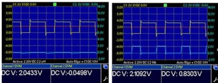
En jaune voie 1 : signal appliqué sur la base du transistor
