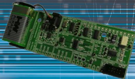
La carte de formation pour Concept4000M permet de découvrir l'ensemble des fonctionnalités du Concept4000M par le biais d'une auto formation guidée. Cette carte conçue avec des circuits simples serait difficile, voire impossible à analyser avec des outils conventionnels, tels que oscilloscope ou multimètre...
